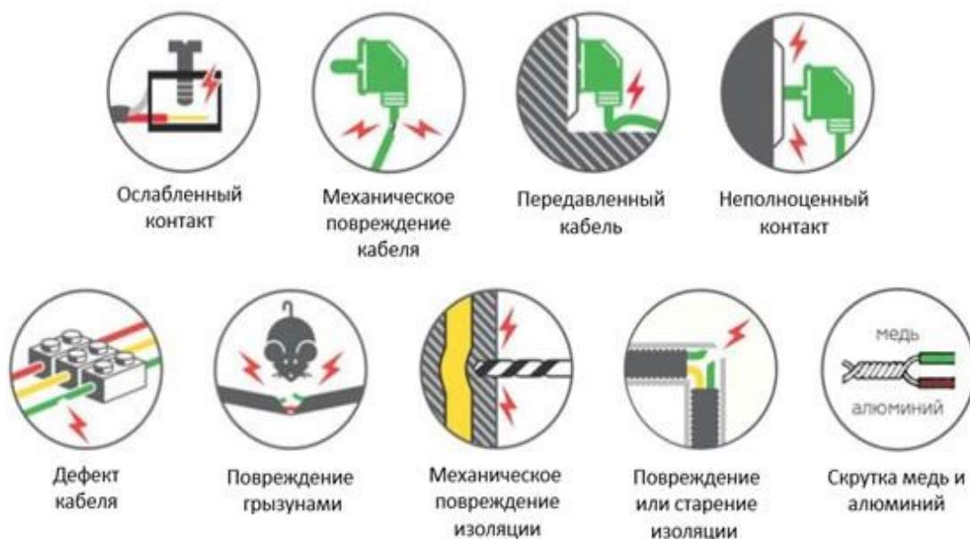
Рисунок 6. Возможные причины искрения в электропроводке
