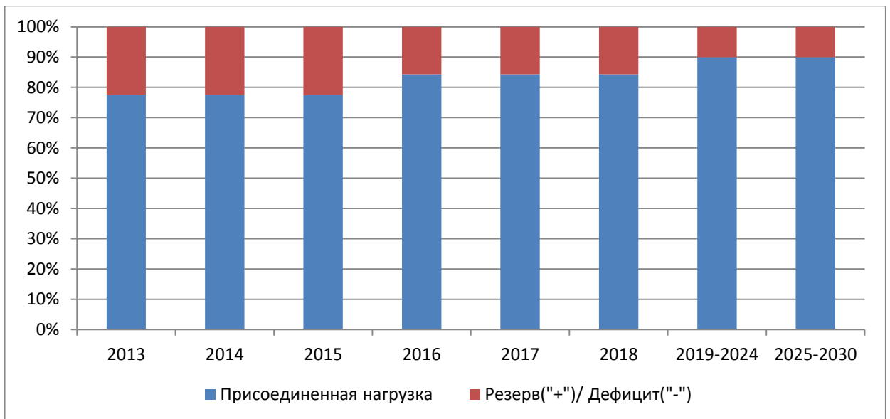
Рисунок 2.3. Балансы тепловой мощности и перспективной тепловой нагрузки котельной №36 д. Сяськелево
